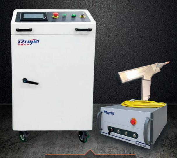
Fuente láser RAYCUS / IPG Cabezal de soldadura láser oscilante. Enfriador de agua. Tablero de control de pantalla. Sistema de alimentación automática de alambre.
